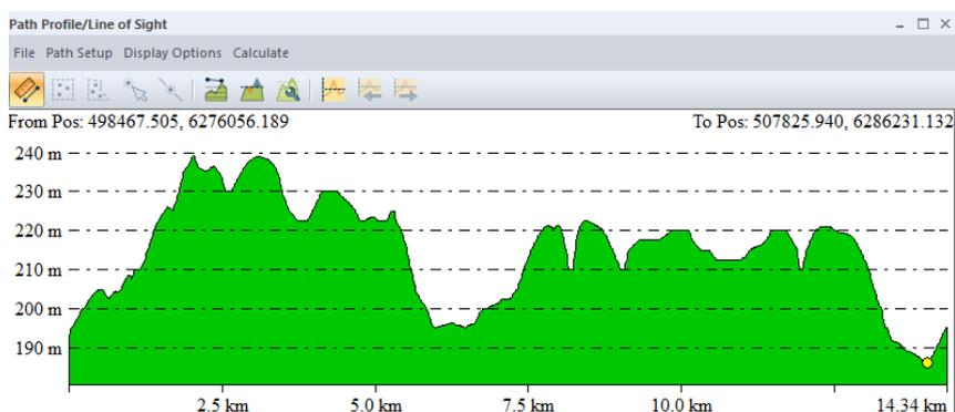
Рис. 9. Профиль рельефа, построенный на основе горизонталей крупномасштабной топографической карты
